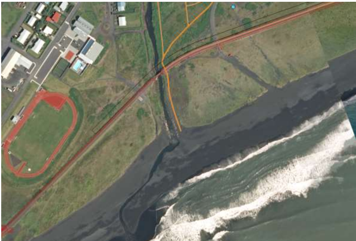
Mynd 10. Skýringaruppráttur sem sýnir tillögu að lega göngustígar undir þjóðveg við Víkurá.
